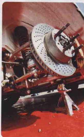
Les deux font appel à des amortisseurs Sachs trois voies mais la 997 (ci-dessus) peut se targuer d'une rigidité supérieure grâce notamment à son train avant en partie monté sur rotules.
