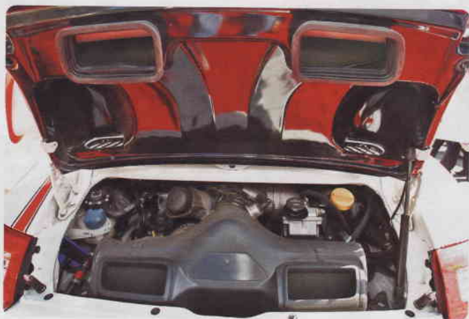
Les deux moteurs demeurent strictement de série. Seule différence visible, la double prise d'air d'admission sur la 997 GT3 RS.
