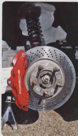
Les deux règlements obligent à conserver les dimensions de série. A l'avant, la 997 (à droite) arbore des disques de 380 mm contre 350 à sa petite sœur la 996.
