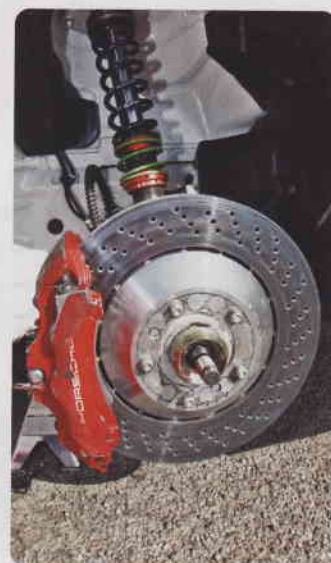
Les deux règlements obligent à conserver les dimensions de série. A l'avant, la 997 (à droite) arbore des disques de 380 mm contre 350 à sa petite sœur la 996.
