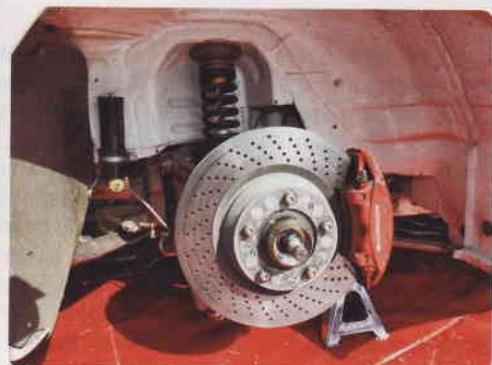
Les deux font appel à des amortisseurs Sachs trois voies mais la 997 (ci-dessus) peut se targuer d'une rigidité supérieure grâce notamment à son train avant en partie monté sur rotules.
